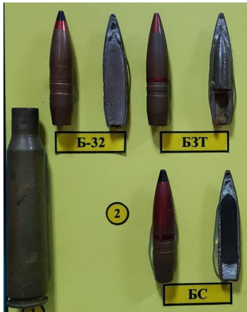
Рис. 3.16. Патрон калібру 12,7x108 мм (кулемет НСВТ): гільза «ГЛ» (1), куля типу «Б-32», «БЗТ», «БС» та в розтині (2).
