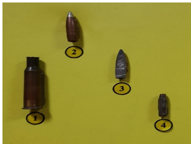
Рис. 3.15. Патрон калібру 7,62x54R мм (гвинтівка СВД): гільза «гс» (1), куля типу «ЛПС» (2), куля в розтині (3), сталеве осереддя (4).
