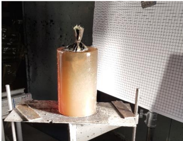
Рис. 3.5. Комбінований балістичний імітатор кінцівки.
