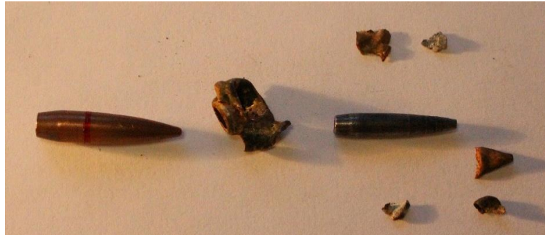
Рис. 3.27. Фрагментація кулі калібру 5,45 мм в желатиновому блоці.
