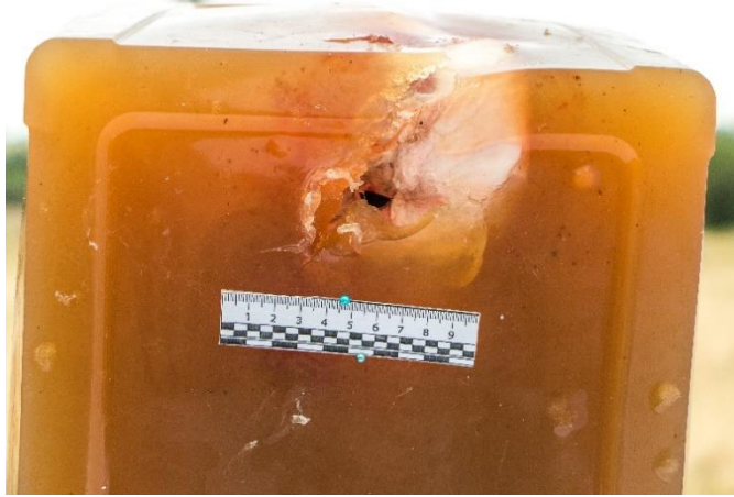
Рис. 3.30. Вихідний отвір імітатору кінцівки після пострілу з гвинтівки СВД калібру 7,62 мм, розліт кісткових уламків на 5 м.
