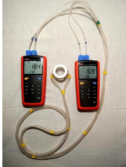
Рис. 2.10. Комплекс вимірювальний інтраопераційний термопарний чотириканальний (КВІТ-4) (патент України на корисну модель 116730).
